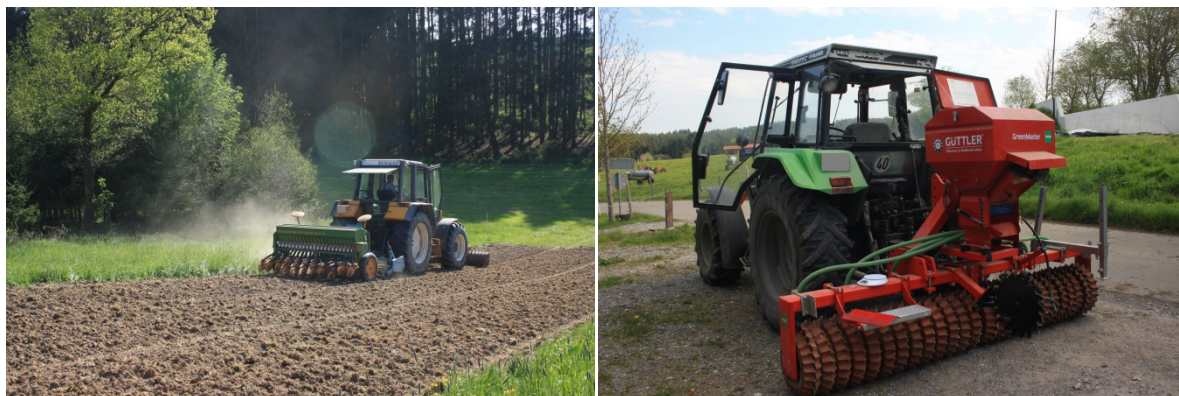
Abb. 11: Praxistaugliche Maschinen zur Ansaat: Drillmaschine kombiniert mit Kreiselegge (links) oder Prismenwalze mit Pneumatikstreuer (rechts)
